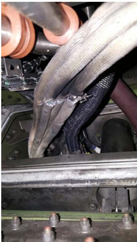
Photo 3 : RJ900 – Pièces de fixation endommagée par des arcs
