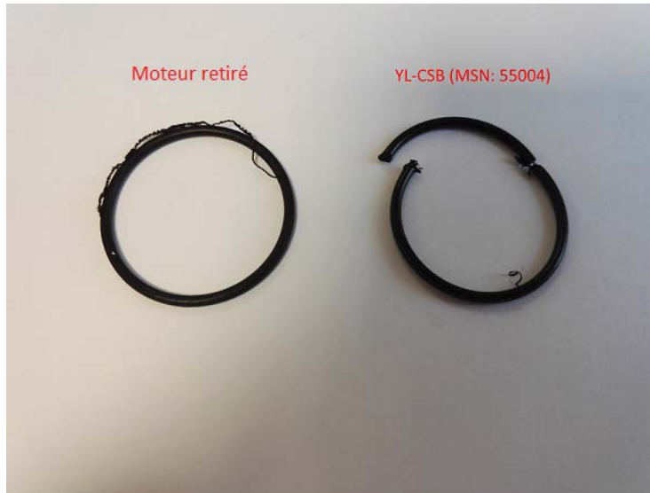
Photo 1 : Joint torique de l'aéronef en question et joint torique d'un autre moteur retiré précédemment.
