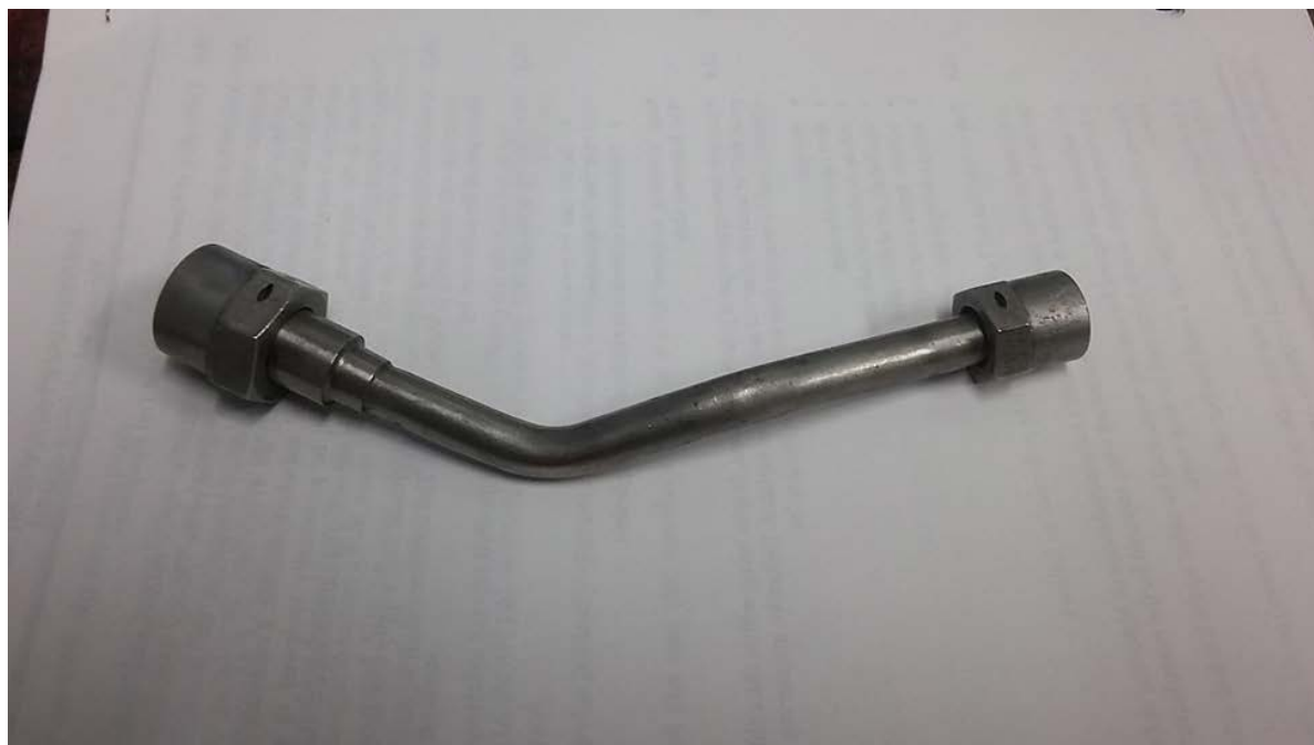
Fissure du raccord d'une conduite de carburant
