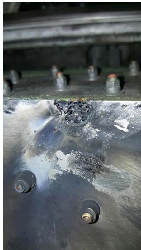
Photo 3 : RJ900 – Pièces de fixation endommagée par des arcs
