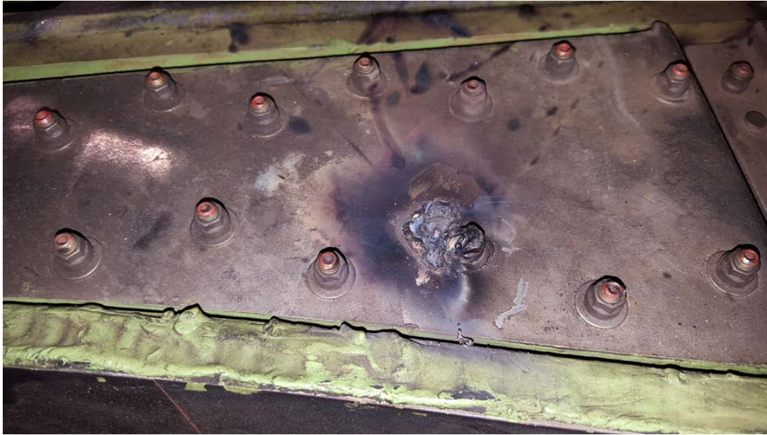
Photo 3 : RJ900 – Pièces de fixation endommagée par des arcs
