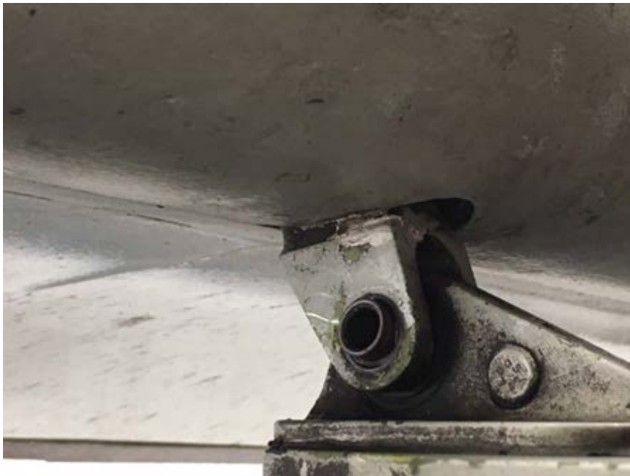
Photo 2 : bague en place dans le raccord retenant le volet
