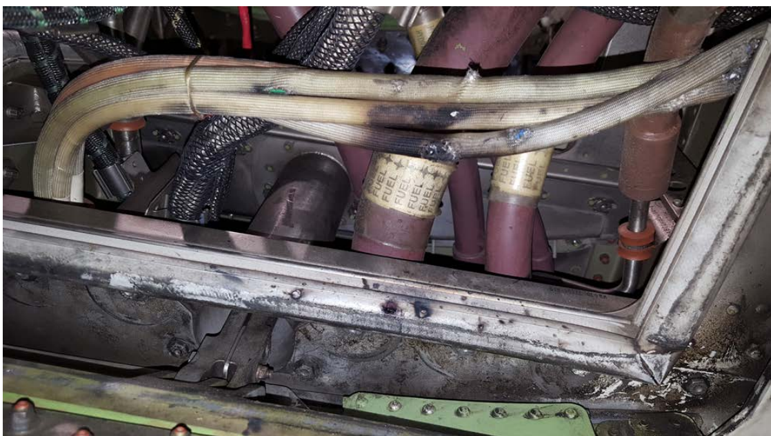
Photo 2 : RJ900 – Câbles brûlés à proximité de la conduite de carburant
