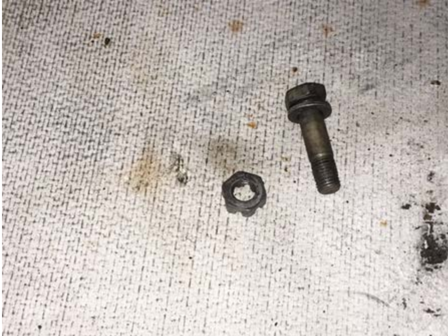
Photo 1 : boulon et écrou trouvé dans la glissière de volet
