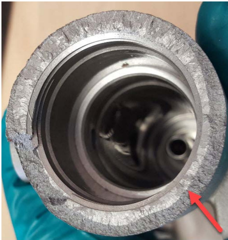
1. Bout de la soupape; on peut voir comment la fissure a progressé.
